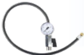
Composé d'un tuyau de remplissage flexible de 60 cm de long. Équipé d'un côté d'un écrou de raccordement Vg8 pour la valve de contrôle du vase d'expansion, de l'autre d'un robinet à boisseau à filetage 7 / 16-28 UNEF pour la bouteille de recharge, et d'un manomètre de contrôle, diamètre 40 mm, classe 1,6.
